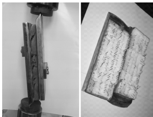
图2 X-cor 夹层剪切破坏模式
